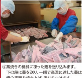
⑤薫焼きの機械に乗った鮫を送り込みます。下の段に薫を送り、一瞬で高温に達した鮫は、鮫の表面を焼き上げ、香りをつけます。
